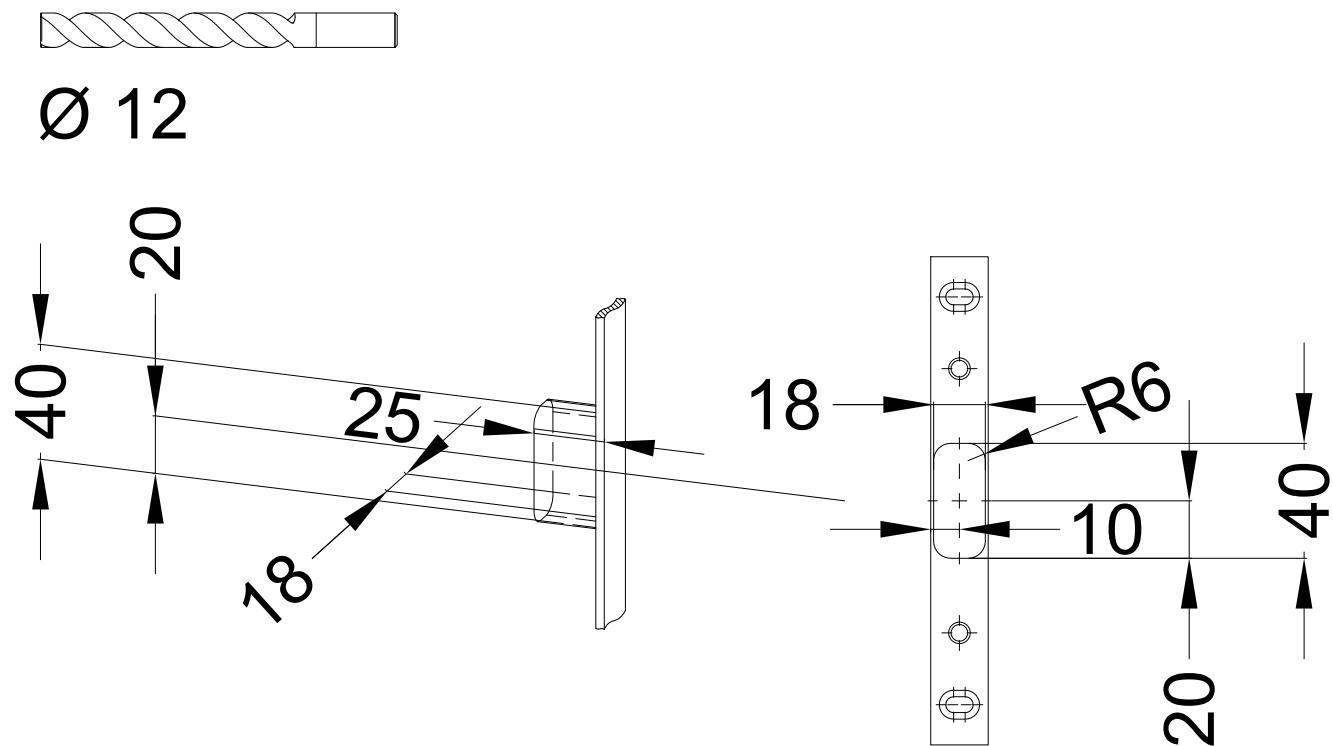
**Einbausituationen der Bauteile mit Fräsmäßen**
