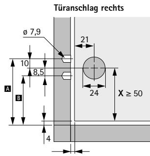
A = Bohrung für Riegel = X + 14
