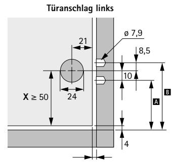
A = Bohrung für Riegel = X - 6
