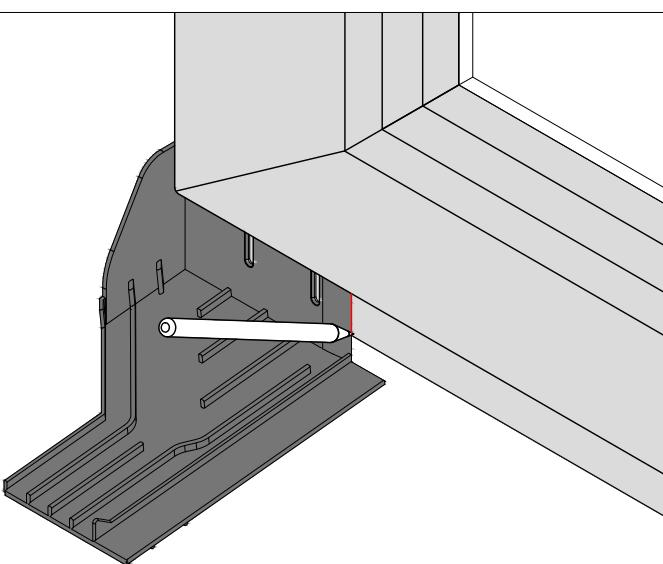
Entwässerungsmodul positionieren und Position am Fensterrahmen anzeichnen.
