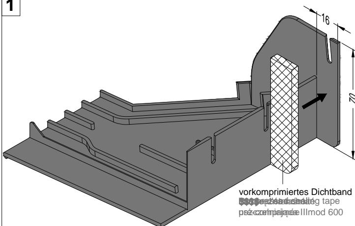
Vorkomprimiertes Dichtband wie dargestellt auf Entwässerungsmodul DELTA aufbringen.
