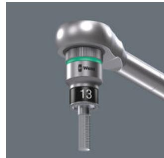
Die Klemmung der Außensechskant-Schraube im Steckschlüsselleinsatz wird durch zwei federnde Kugeln und einen dauerelastischen hochfesten Schrumpfschlauch gewährleistet. Dieser wird durch einen vorderen Stahlbund wirksam gegen mechanische Verletzungen geschützt. Besonders hilfreich in schwer zugänglichen Arbeitsbereichen, wo man die zweite Hand nicht zum Festhalten der Schraube nutzen kann.
