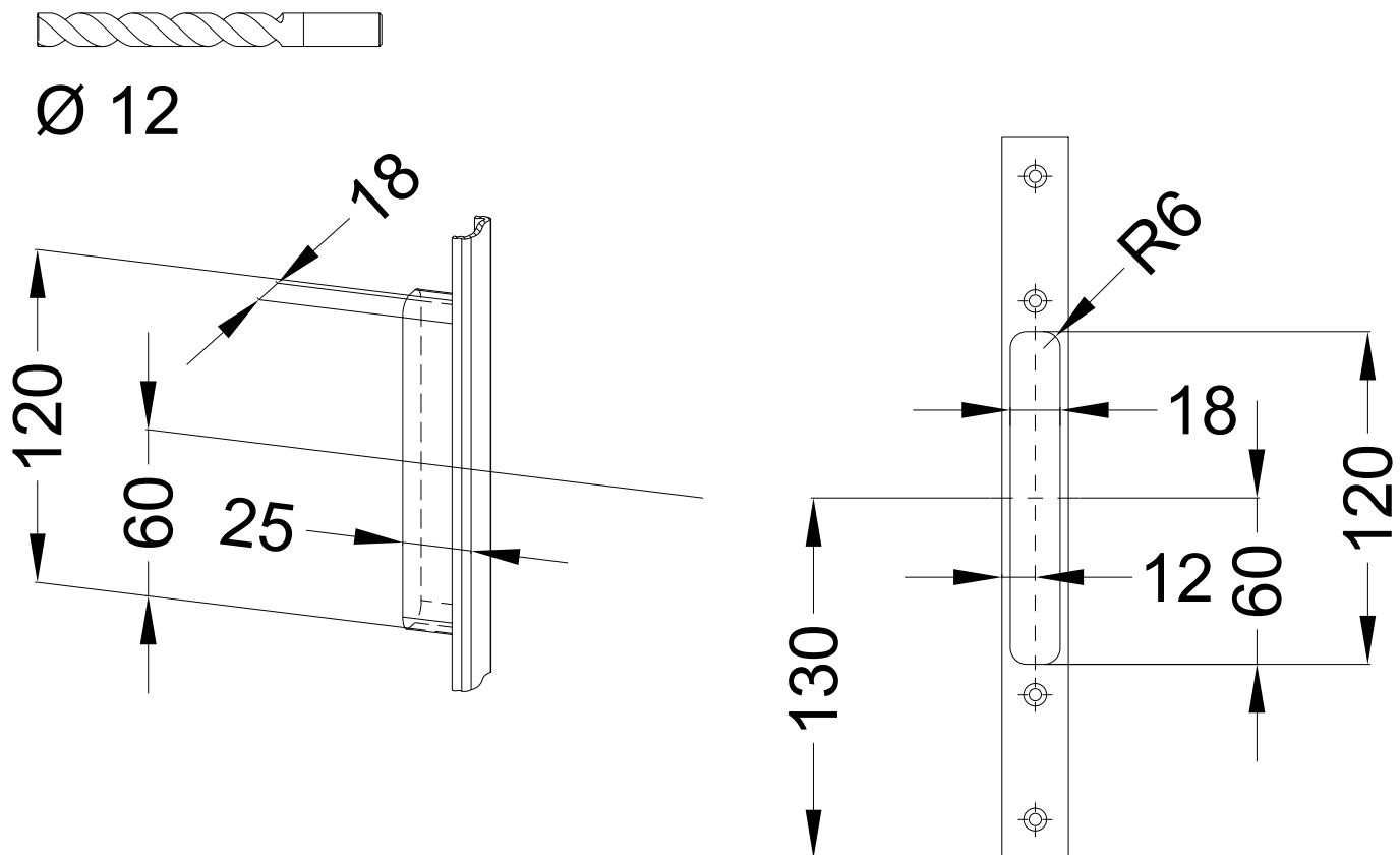
**Einbausituationen der Bauteile mit Fräsmäßen**
