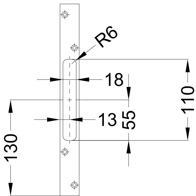
**Einbausituationen der Bauteile mit Fräsmäßen**
