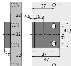
► Zum Anschrauben mit Direktbefestigungsschrauben ø 6,3 mm im System 32
