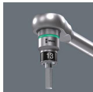
Die Klemmung der Außensechskant-Schraube im Steckschlüssleinsatz wird durch zwei federnde Kugeln und einen dauerelastischen hochfesten Schrumpfschlauch gewährleistet. Dieser wird durch einen vorderen Stahlbund wirksam gegen mechanische Verletzungen geschützt. Besonders hilfreich in schwer zugänglichen Arbeitsbereichen, wo man die zweite Hand nicht zum Festhalten der Schraube nutzen kann.
