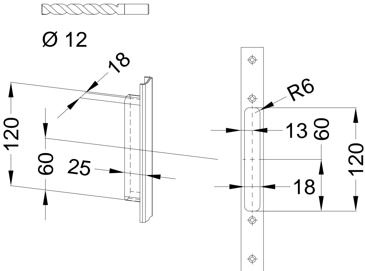
**Einbausituationen der Bauteile mit Fräsmassen**
