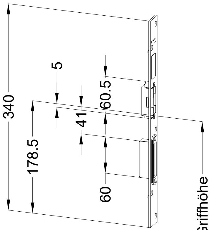
**Einbausituationen der Bauteile mit Fräsmäßen**
