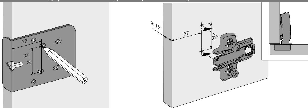
Ankörnposition für Kreuzmontageplatte bei einliegender Front (19 mm dick)
