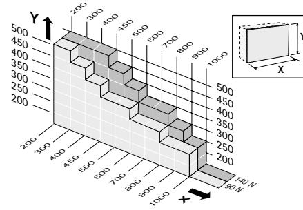
Basierend auf Spanplatte 19 mm, 700 kg / m<sup>3</sup>
