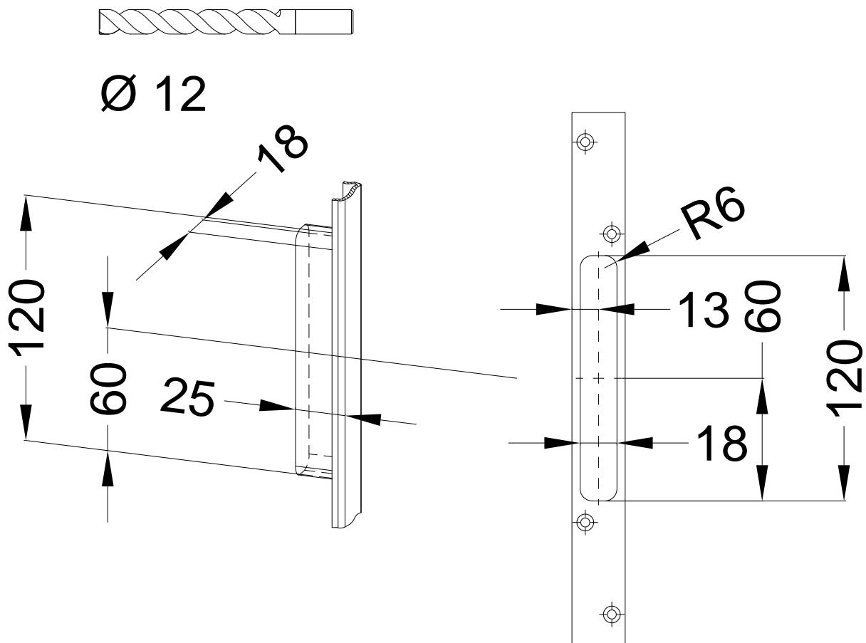
**Einbausituationen der Bauteile mit Fräsmäßen**
