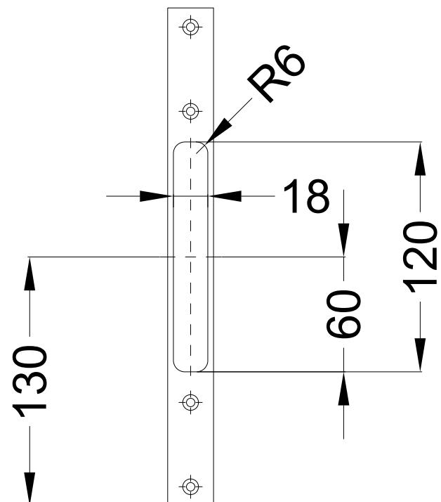
**Einbausituationen der Bauteile mit Fräsmäßen**
